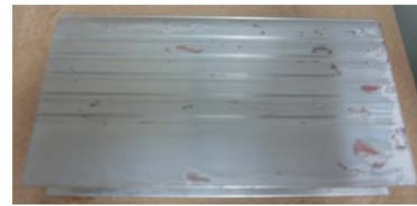
図1 キャス試験前後のアルミニウム陽極酸化皮膜の外観
