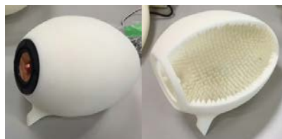
3Dプリンターの特長を活かした 製品のダイレクト造形 (スピーカーとその内部形状)
