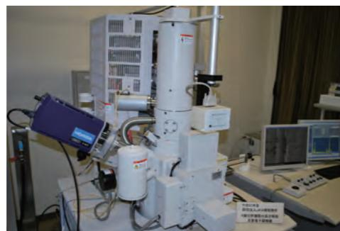
X線分析機能付高分解能走査電子顕微鏡
