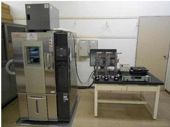
写真 損失係数測定装置
