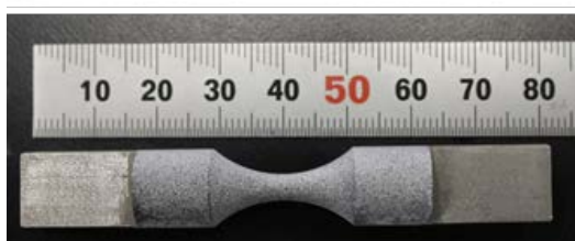
図1 ランダムパターンを塗布した試験片
