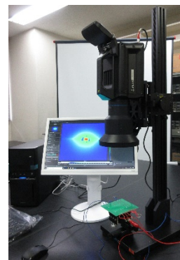
写真1: 赤外線サーモグラフィ
