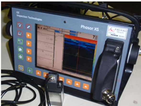
図1 超音波探傷器の外観
