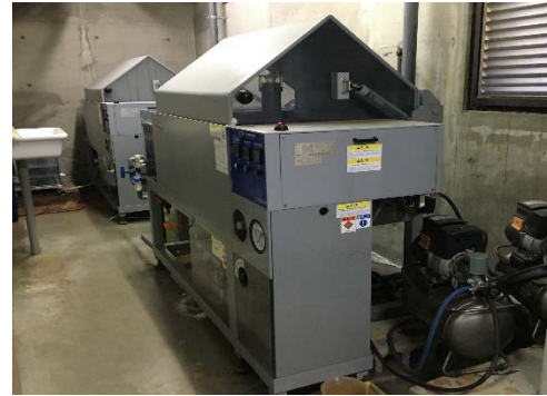
写真 塩水噴霧試験機(手前)、キヤス試験機(奥)
