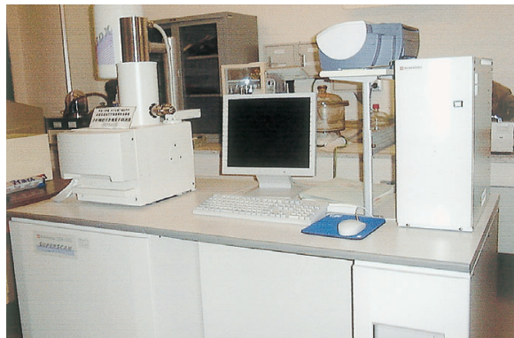
写真2：分析機能付走査電子顕微鏡 (島津製作所・SSX-550)
