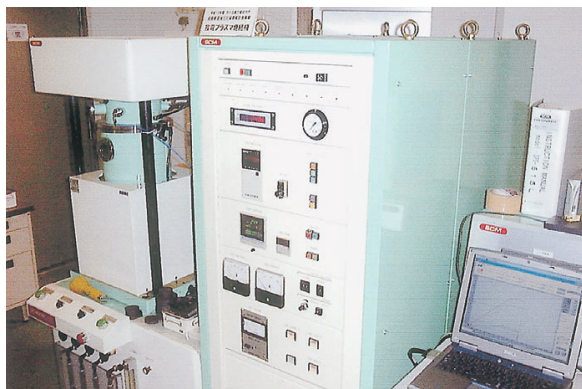
写真1：放電プラズマ焼結機 (住友炭鉱業・SPS-515L)
