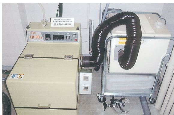
写真3：遊星型ボールミル (伊藤製作所・LP-4)
