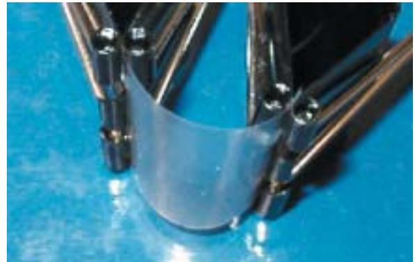
写真は、ポリ乳酸にバイオマス由来の低分子量ポリマーを添加して試作したフィルムです。ポリ乳酸が柔軟化されることにより、耐折性が向上し、伸びなどの物性が改良されています。今後、これらの材料の実用化に向けて、産業界のニーズに合った、ポリ乳酸のさらなる物性改良の実現に努力していきたいと思っておりますのでご利用、ご活用をお待ちしています。
