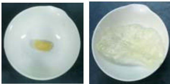
図1 グルコースとPEG（平均重合度68）から合成した高分子ゲルの水に対する膨潤挙動（左：膨潤前、右：膨潤後）
