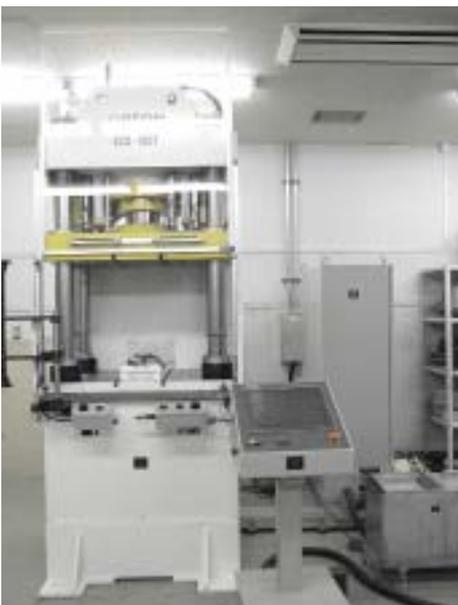
写真1 万能塑性加工試験機
