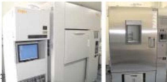
写真5 プリント基板・はんだ導体抵抗評価システム
