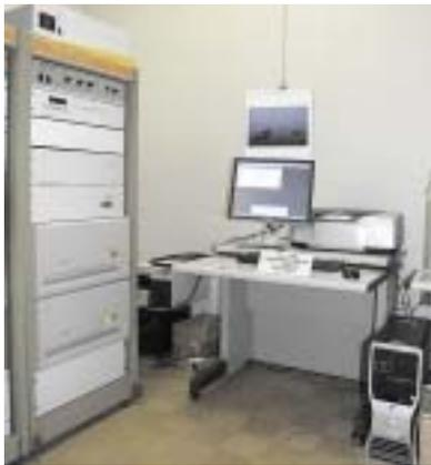
写真4 オージェ電子分光測定制御装置
