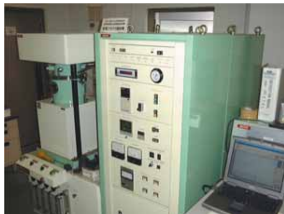
写真1：当所の放電プラズマ焼結機（SPS） （SPS シンテックス㈱ 製 SPS-515L）
