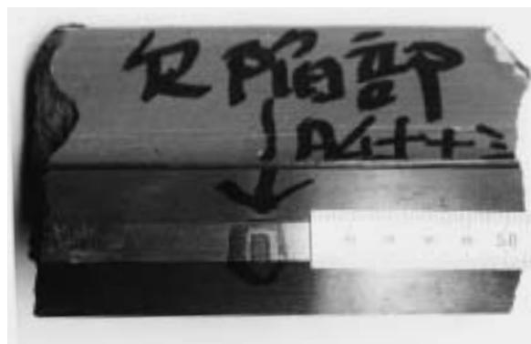
図1 異物混入箇所の外観
