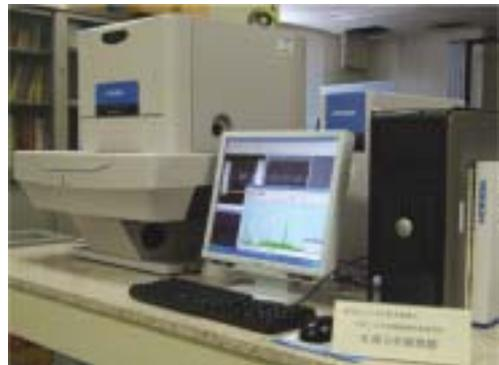
写真3 X線分析顕微鏡
