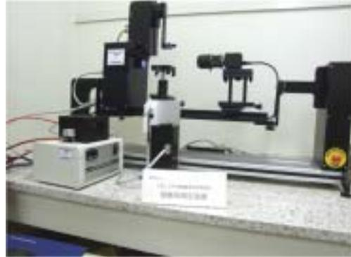
写真2 接触角測定装置
