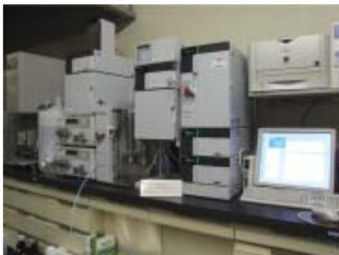
写真4 分取液体クロマトグラフシステム
