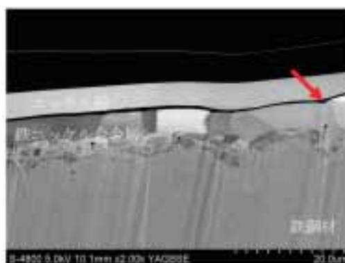
写真4 熱処理後のニッケルめっきの断面組織
