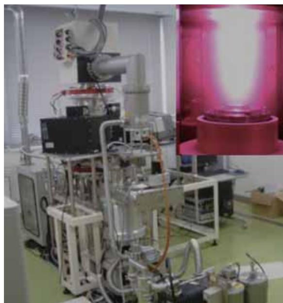
図 電子ビーム励起プラズマ装置
