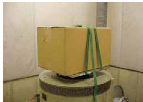
図2 垂直方向の固定例
