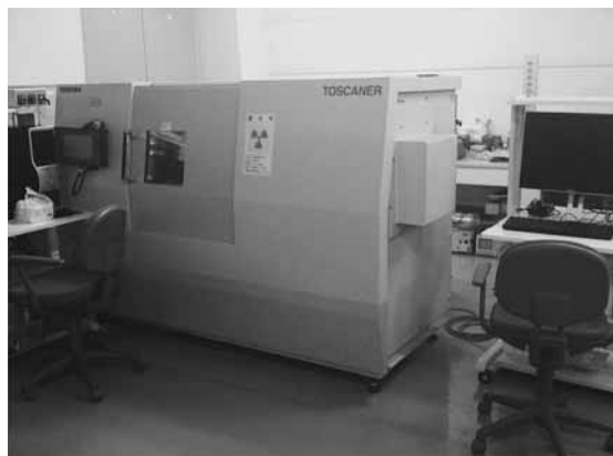
写真1 X線CT 東芝ITC製Toscaner-32252 \mu\text{hd}
