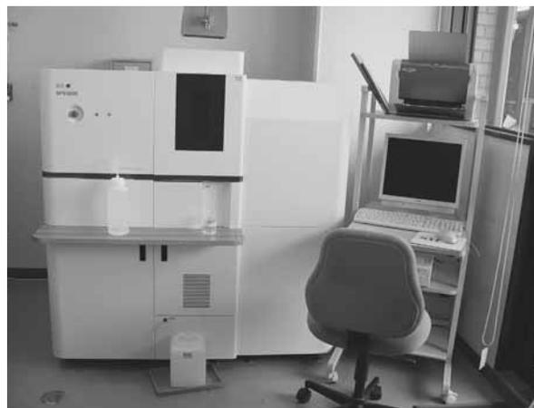
図1 新規導入したICP発光分光分析装置
