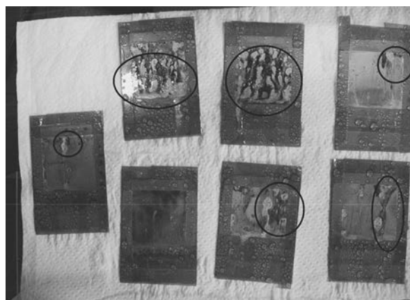
図3 塩水噴霧試験後の亜鉛めっき上の化成 処理皮膜（黒線内が腐食の発生した部分）
