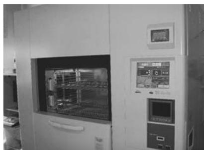
写真1 冷熱衝撃装置
