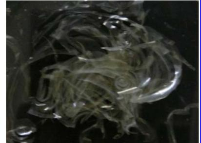
写真2 ナノセルロースを乾燥して得られた透明フィルム
