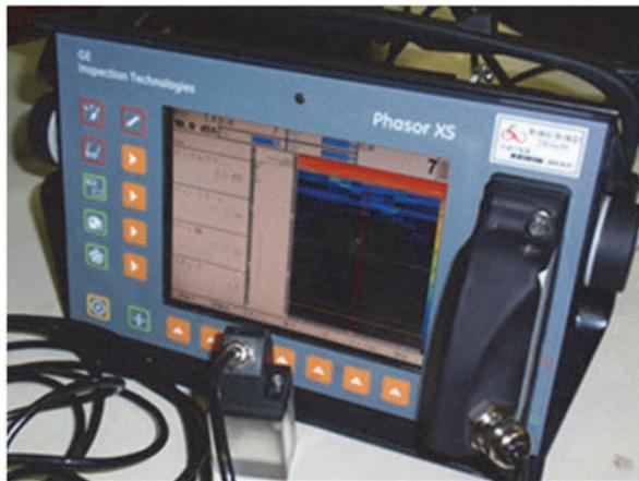
図1 超音波探傷器の外観
