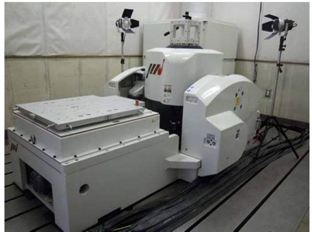
写真1 コンポジット部材振動特性評価解析装置
