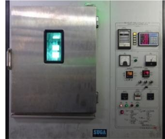
写真 強エネルギーキセノンウェザーメーター
