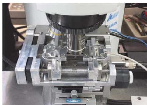
図2 その場観察式応力負荷装置 (ISL-T300)
