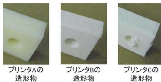
図1 同じモデルを用いた造形物の撮像
