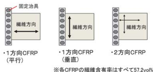
図2 CFRPの繊維配向
