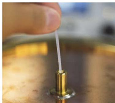
空洞共振器に挿入される被測定材料
