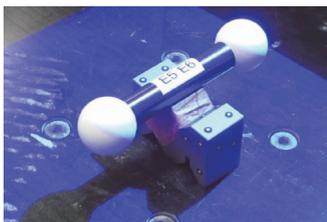
図2 校正値付きダンベル器物
