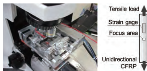
図 2 ステージ上の材料試験機および試料
