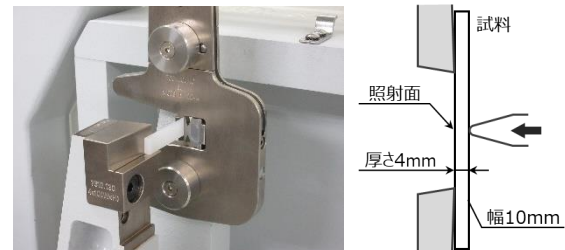
図2 衝撃曲げ試験方法
