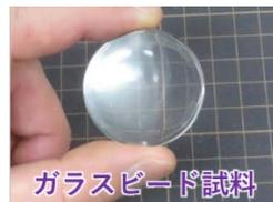
二酸化ケイ素と硫酸カリウムの 1:1 混合物の粉末を、プレスして固めた圧粉体試料と、ガラスビード試料にしたものの分析結果を示します。
