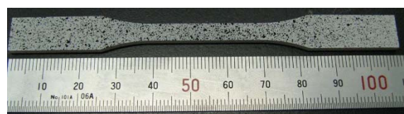
DIC 解析用のランダムパターン塗布をした試験片
