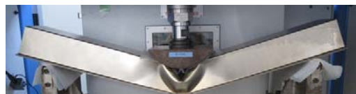
図2 衝撃圧縮した自動車構造部材模擬試験片
