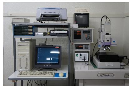
図2 非接触三次元測定装置
