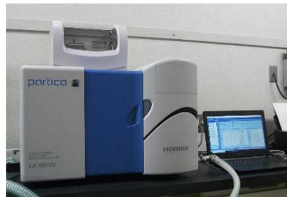
図 粒子径分布測定装置
