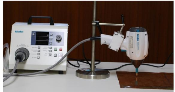
図 ノイズ対策の実習で使用する静電気試験機
