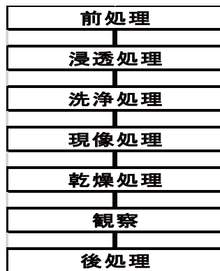
図 2 本研究における蛍光浸透探傷試験の手順
