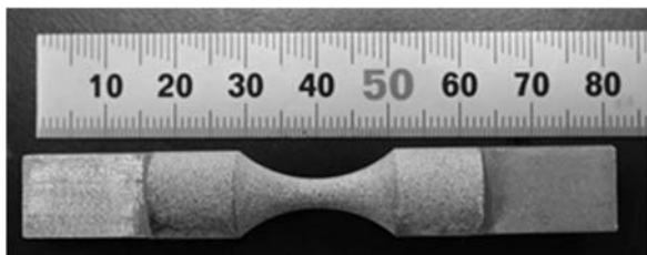
図 2 ランダムパターンを塗布した 切欠き付き丸棒試験片
