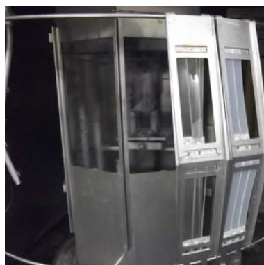
図2 促進耐候性試験機の設置の様子
