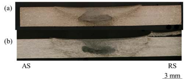
図 4 FSW による同種材料接合の断面顕微鏡組織観察 (a)A2024-T3、接合速度：200 mm/min (b)A7075-T651、接合速度：200 mm/min
