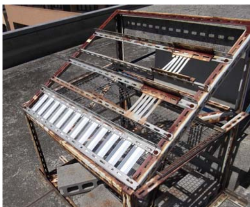
図1 屋外暴露試験の設置の様子(最下段)
