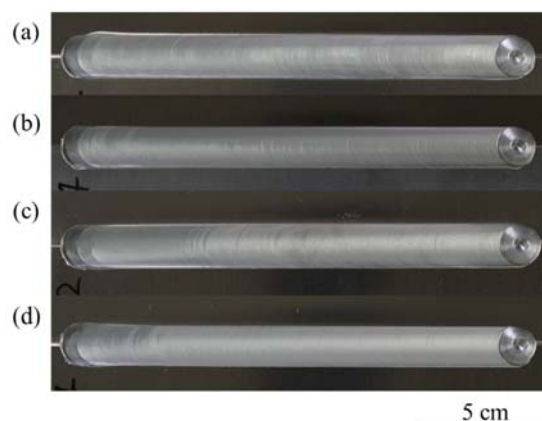
図 7 FSW による異種材料接合(A5052-0×A6061-T6)の外観写真
