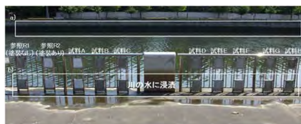
図 1 堀川護岸での試験状況 a) 護岸の黒ずみ、b) 参照 R1、R2 及び試料 A~試料 H
