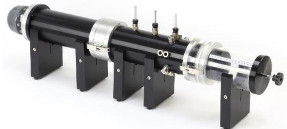
図 4 垂直入射吸音率測定時の装置構成
