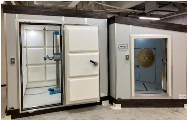
図 1 吸音率・音響透過損失測定装置
