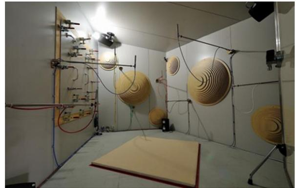
図 2 残響室法吸音率測定時の装置構成
