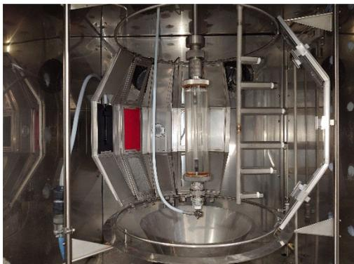
図1 キセノンウェザーメーター
