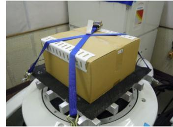
図1 包装貨物の振動試験例
