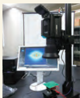
赤外線サーモグラフィ
