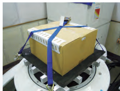
図1 包装貨物の振動試験例
