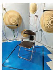
図2 パイプ椅子の等価吸音面積測定
