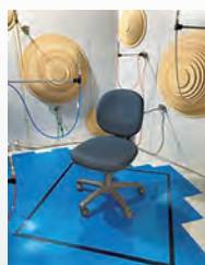
図1 回転椅子の等価吸音面積測定
