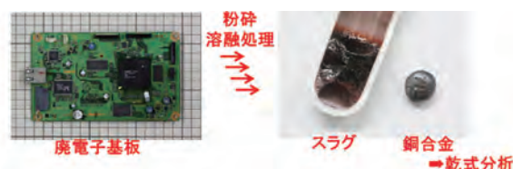
図1 本研究の廃電子基板の乾式前処理法
