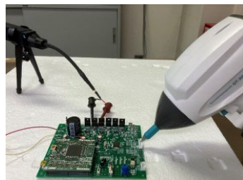
図2 ESD 試験とノイズ測定
