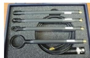
図3 電磁界プローブ
