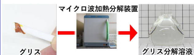
図 1 グリスの分解・水溶液化
