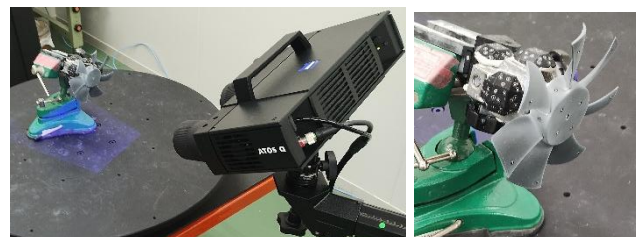
左：非接触三次元デジタイザによる測定 右：測定対象例（PC ケースファン）
