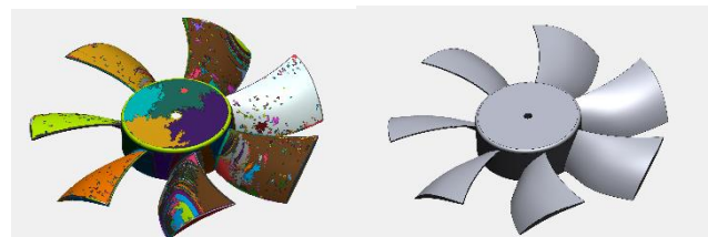
左：同一ジオメトリ形状の領域を分割した STL データ 右：リバースエンジニアリングで作成した 3DCAD データ
