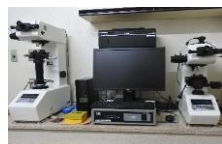
(左側) ビッカース硬さ試験機 (右側) マイクロビッカース硬 さ試験機
